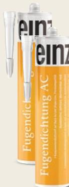
Sigillante elasto-plastico monocomponente a base di resina acrilica in dispersione acquosa, per interni ed esterni. einza Fugendichtung AC viene fornito in forma pastosa e stabile. Dopo la lavorazione il materiale asciuga per evaporazione della parte d'acqua in un sigillante elasto-plastico. einza Fugendichtung AC teme il gelo. Per la sigillatura di giunti e raccordi tra vari materiali edili. Dopo completa essiccazione, einza Fugendichtung AC è sovraverniciabile con smalti e pitture.
